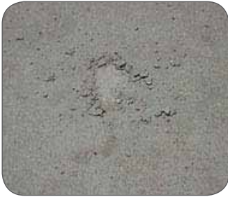
Fig. 4 Bij puntbelasting verpulvert het toplaagje
