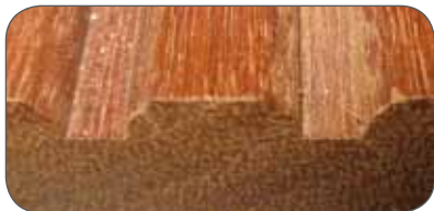
Fig. 5: Gladde, dichte Azobé oppervlak
