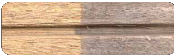
Fig. 4: behandeld – verweerd oppervlak
